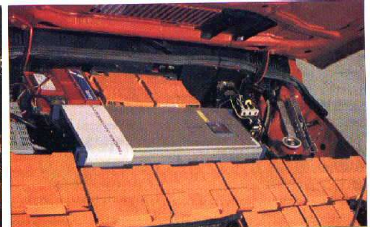
Το σύστημα συσσωρευτών και ο ενσωματωμένος φορτιστής των
